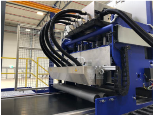
Inline-Beschichtungsmodul mit volumetrisch arbeitender Zahnradpumpeneinheit und über beheizte Schläuche sektional versorgte Breitschlitzdüse.
