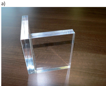
Abb. 2: Versuchsklebung von PMMA; a) rechtwinkliges Werkstück: Die beiden Werkstücke sind perfekt miteinander verbunden. An der Gehrungsklebung ist ein idealer optischer Übergang zu erkennen, welcher die Transparenz des fertigen Musterstücks deutlich erkennen lässt (Quelle: Schäfer Kunststofftechnik GmbH); b) Beispielanwendung mit Acrylglas (PMMA): die blau getönte Haube dient der Sicherheit und Qualitätskontrolle an der Maschine
