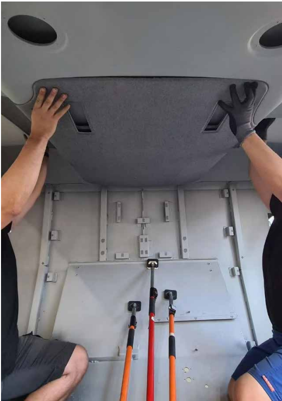
Anlegen des Dachhimmels
