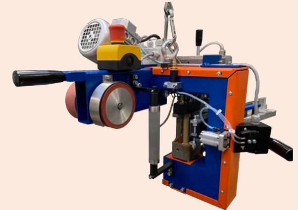
Das Hand-Kanten-Anleimgerät, kurz HKA, mit Leimangabe wurde speziell für stationäre Anwendungen bei Montagearbeiten entwickelt. Über die externe Steuerung können Temperaturen, Drehzahl, Drehrichtung, Arbeitsplatzbeleuchtung und eine optionale Absaugungsvorbereitung eingestellt werden.
