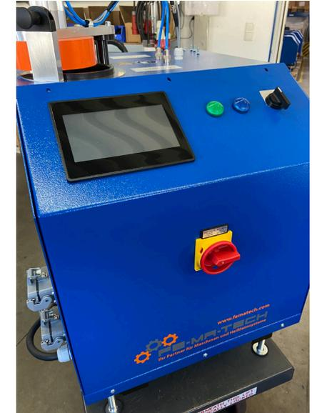
Die Klebstoffe werden in zwei separaten Tanks aufgeschmolzen und ermöglichen einfaches Arbeiten mit zwei Farben. Die Klebstoffe werden nicht gemischt.
